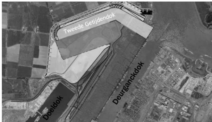
Figuur 4. Onderdeel van het voorkeursalternatief voor het complex project ECA, nl. de havenuitbreiding aan het Tweede Getijdendok. Ten zuiden van het Tweede Getijdendok voorziet het voorkeursalternatief ruimte voor containerbehandeling (= de rode zone). De gele zone tussen de terminal en het Doeldok is gereserveerd als logistieke zone.
